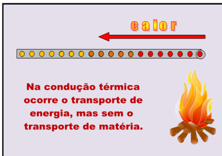
Figura 08 – PROPAGAÇÃO DO CALOR AO LONGO DE UMA BARRA
