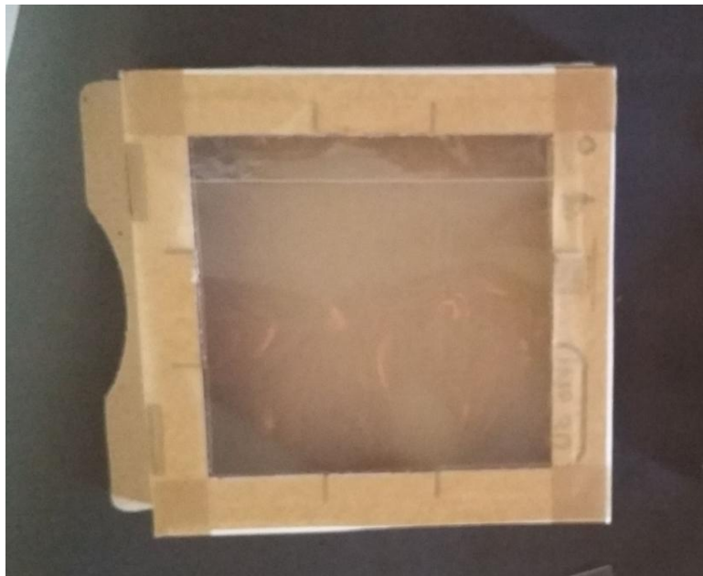
Figura 28 - FITA GOMADA COBRINDO A PARTE EXTERNA, ONDE FOI FEITO O ENCAIXE ENTRE A PASTA E A CAIXA.
