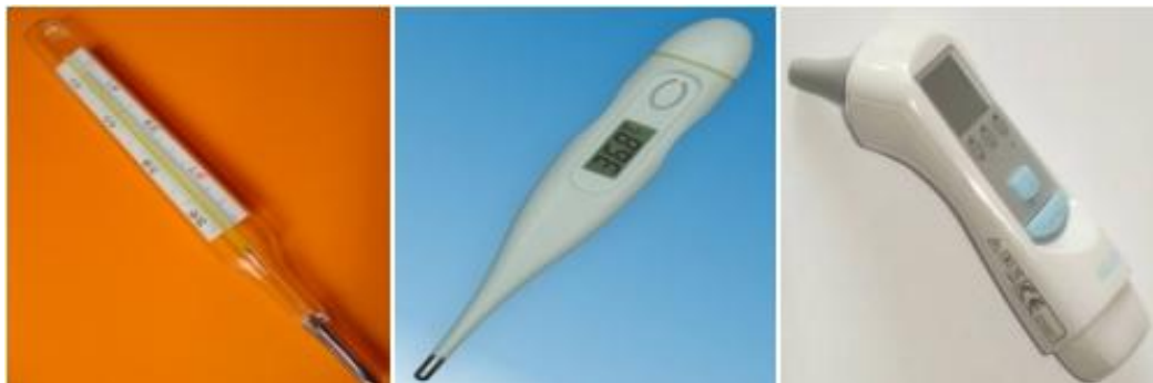
Figura 05 – MODELOS DE TERMÔMETROS, DE MERCÚRIO (ESQUERDA), DIGITAL (CENTRO) E INFRAVERMELHO (DIREITA)
