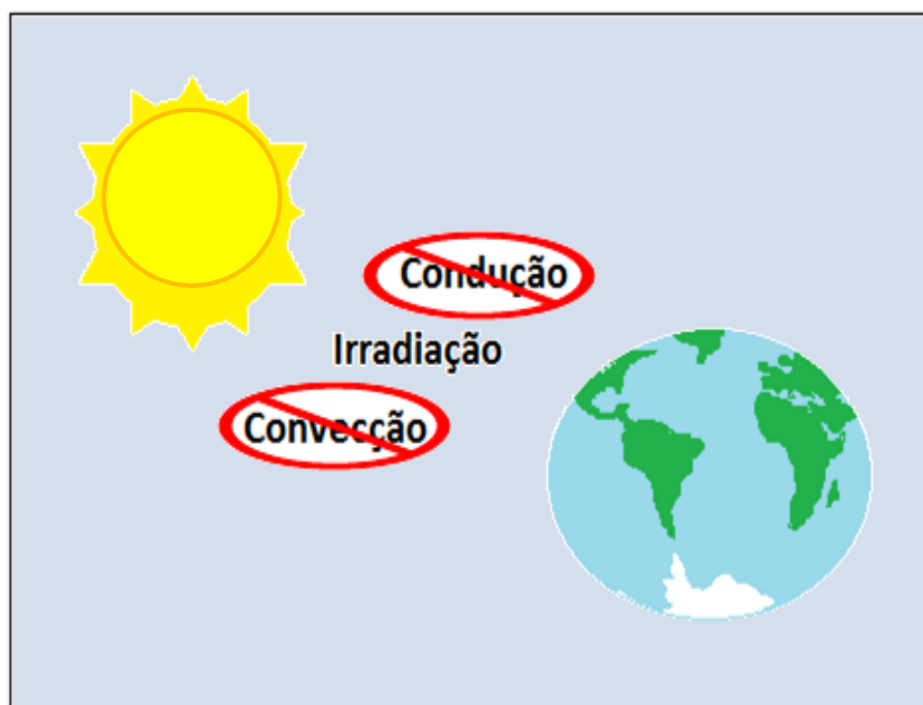
Figura 11 – ENERGIA DO SOL CHEGA ATÉ A TERRA POR RADIAÇÃO TÉRMICA
