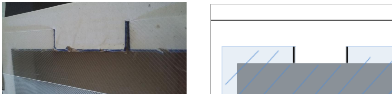
Figura 25: MANEIRA DE ENCAIXAR A PASTA NA CAIXA, VISTA EXTERNA. IMAGEM REAL A ESQUERDA E ILUSTRAÇÃO À DIREITA
