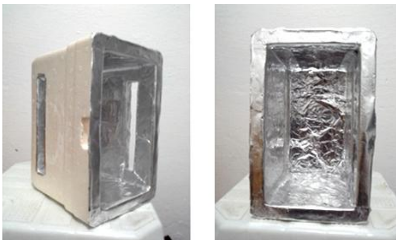
Figura 38 – CAIXA DE ISOPOR COM OS CORTES REALIZADOS E COM O PAPEL ALUMÍNIO COLADO NO INTERIOR DA CAIXA.
