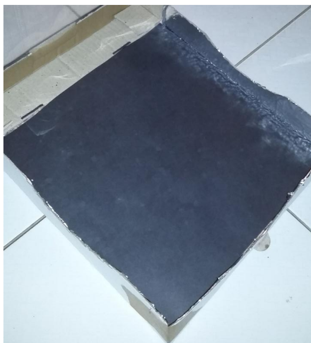
Figura 32: PAPEL PRETO COLADO NO FUNDO INTERNO DO FORNO SOLAR
