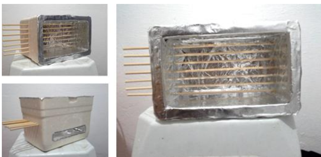
Figura 39 – CAIXA DE ISOPOR COM OS PALITOS FIXADOS
