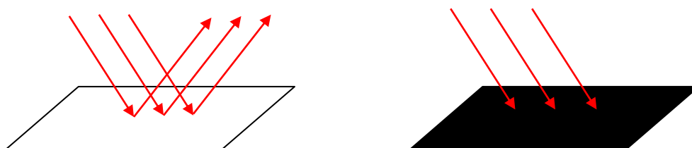
Figura 12 – COMPORTAMENTO DOS RAIOS SOLARES EM MEIOS CLAROS E ESCUROS.
