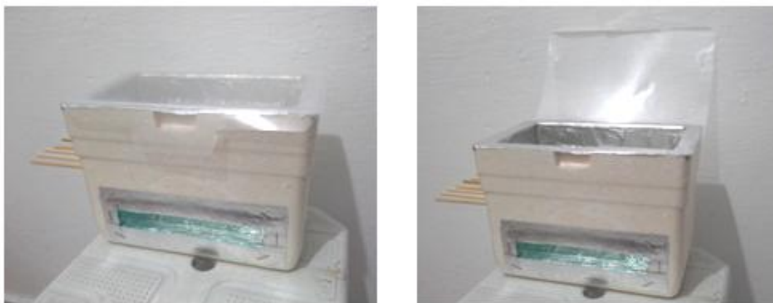
Figura 41 - TAMPA DE PASTA ESCOLAR, COLADA NO SECADOR.
