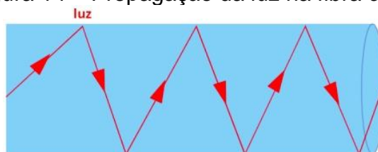
Figura 14 – Propagação da luz na fibra ótica.
